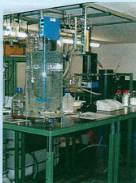
TECHNIKUMSVERSUCH: Grubenwasser-Reinigungsanlage der GFI GmbH Dresden Bild 3
